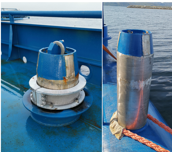
Figur 32: Aquatraz G2 hanefotinnfesting, pullert, kjettingpipe og koblingsselement mellom merd og flytekrage
