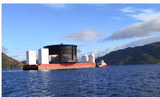
Figur 19: Transport av Aquatrax 1 fra verft til lokalitet
