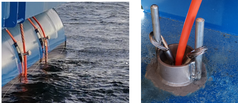
Figur 24: Flyttbar kabelavhenging og kabelgjennomføringer
