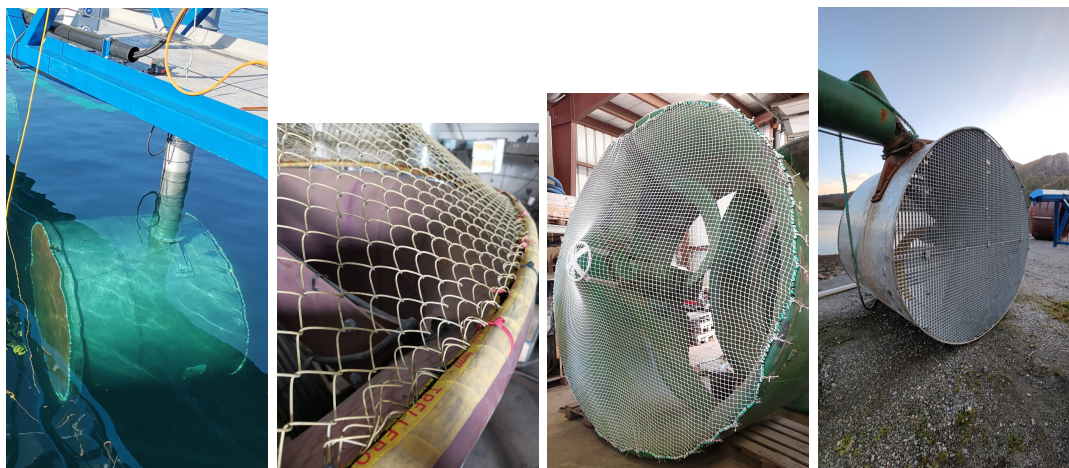
Figur 23: Innløpsbeskyttelse på strømsettere. Fra venstre: Plan innsugsbeskyttelse - Konisk innløp og messing innsugsbeskyttelse - Konisk innløp og strikkinnspent not - Plan innsugsbeskyttelse med stålgitter
